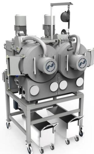
Die neue Baugröße 2/406 des EREMA Laserfilters ist mit der deutlich größeren Siebfläche optimal für Anwendungen geeignet, bei denen die Durchsatzleistung im Vordergrund steht.
