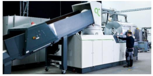
*PET-Endlosfasern und Gewebe lässt sich mit der Shredder-Extruder-Technologie ISEC evo sehr gut recyceln.*
